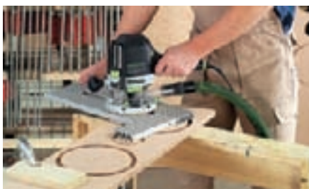
Einfaches Erstellen von runden Ausschnitten.
