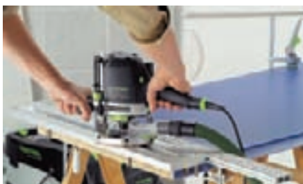
Mit der Arbeitsplatten-Frässschablone sind Eck- und Plattenverbindungen zügig hergestellt.
