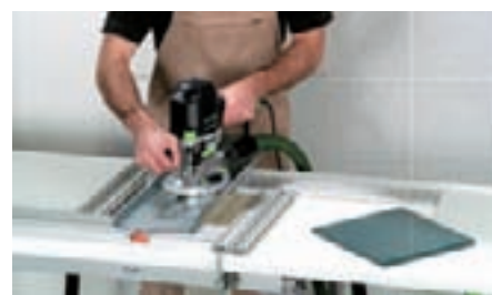
Flächige Ausfräsungen können einfach und sauber mit dem Frässchlitten MFS-FS erledigt werden.
