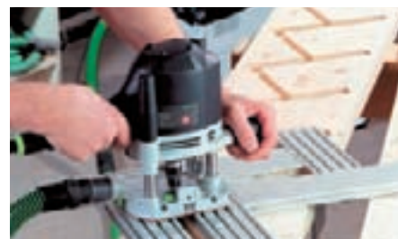
Treppenwangen können durch die Verlängerungsprofile passgenau abgebildet werden.
