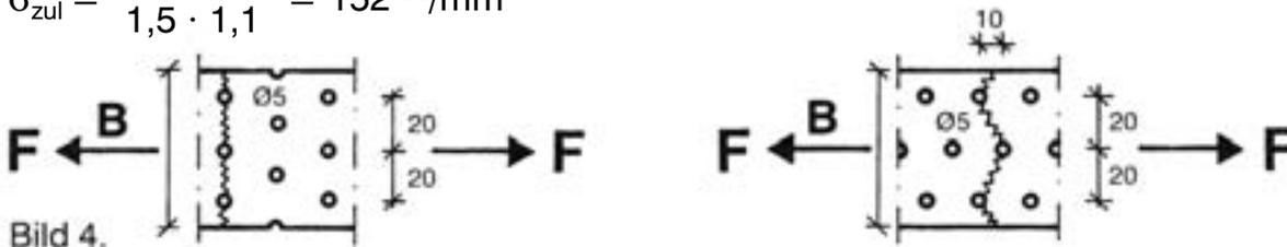
Bei Festlegung der Querschnittsfläche soll die Lochfläche abgezogen werden. Die Figuren oben zeigen, daß diese 25% der Totalfläche bei beiden Krafrichtungen betragen.
