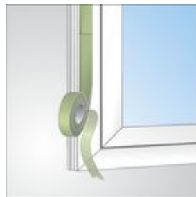
Bild 3: Stumpfstoß bei der Fenstermontage
