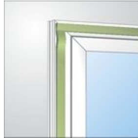
Bild 1: Eckauslegung bei der Fenstermontage
