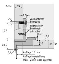
Spanplatten-Senkkopfschraube ø 4 x 16 mm, vernickelt, Bestell-Nr. 010 085, VE 200 Stück
