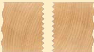
Die Verzahnung und die daraus resultierende Vergrößerung der Leimfläche garantiert höchstmögliche Festigkeit der Holzverbindung.
