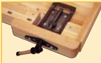
Neu entwickelte parallel spannende Vorderzange mit seitenstabiler Flacheisenführung, die auch bei starker einseitiger Belastung des Spannbackens einen gleichmäßigen Druck auf die gesamte Zangenbreite ausübt.
