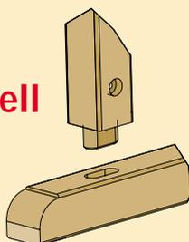
Alle Fußgestelle sind mit einer hochwertigen Schlitz-Zapfen-Verbindung für optimale Standfestigkeit ausgestattet.
