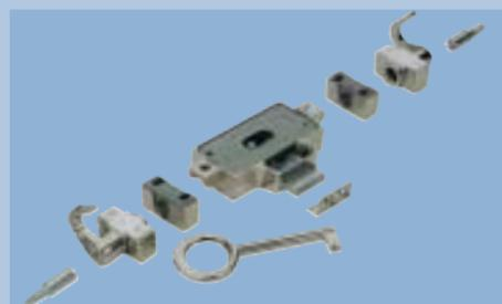
Drehstangenschlösser können bei hohen Schranktüren rückseitig aufgeschraubt werden. Die Schließhaken greifen dabei hinter Anschlagstifte, die im Schrankinneren angebracht werden (Dreipunkt-Verriegelung).
